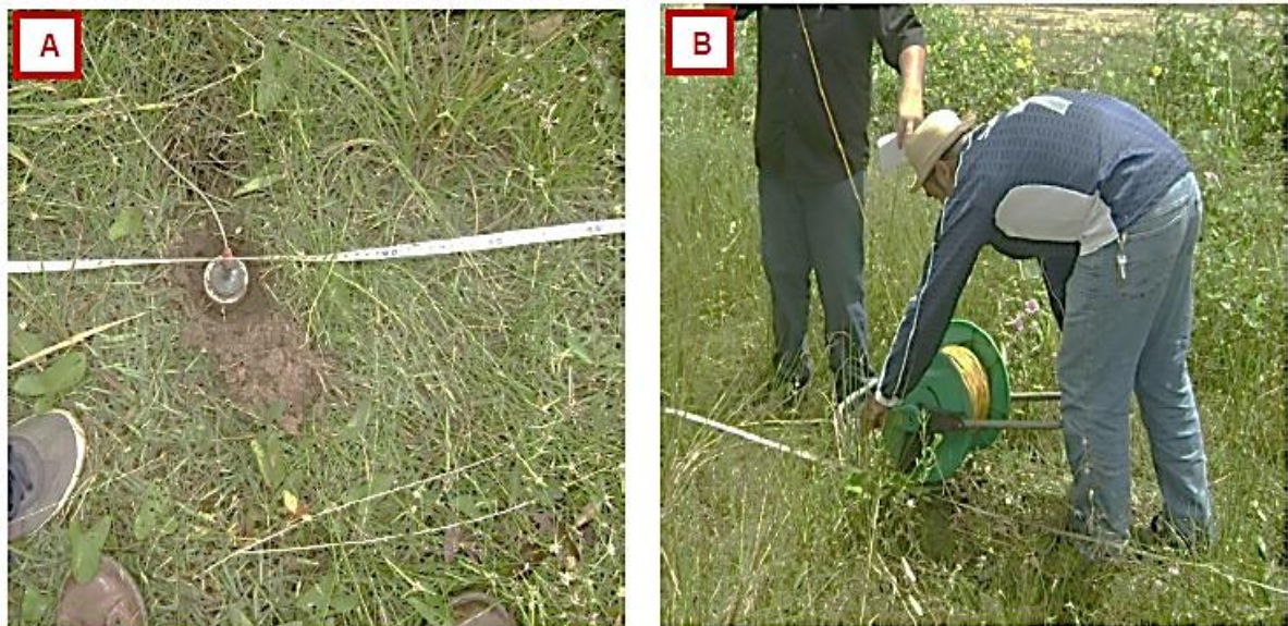
Figura 13. A - Foto ilustrando o posicionamento do eletrodo usado no levantamento, livre de raízes e grama. B - Bobina, contendo o cabo que acompanha o deslocamento do eletrodo pelas estações de medição.
