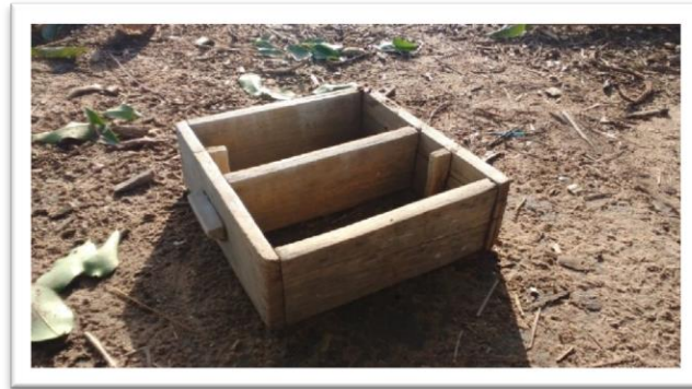
Figura 7 – Fôrma em madeira para confecção dos tijolos de adobe Fonte: Dos autores
