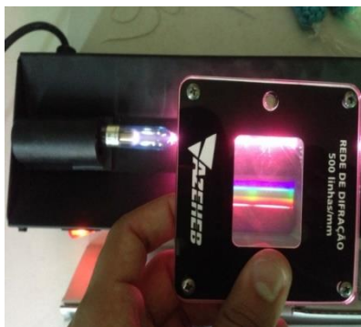
Fig. 05: As raias espectrais da lâmpada de mercúrio vistas através da rede de difração.
