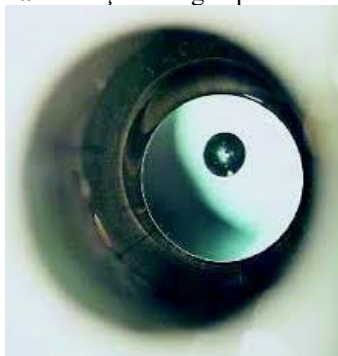
Figura 2: Porção de água pura levitando.
