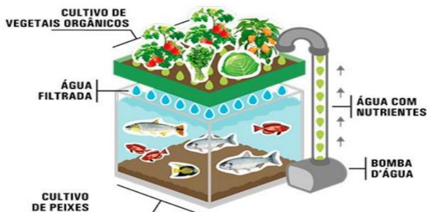
Figura 1. Sistema básico de aquaponia
