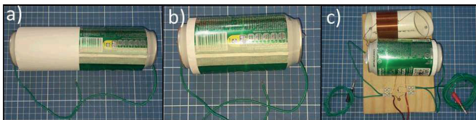
Figura 6 – Capacitor improvisado com lata de refrigerante: a) aberto, b) fechado e c) instalado no rádio
