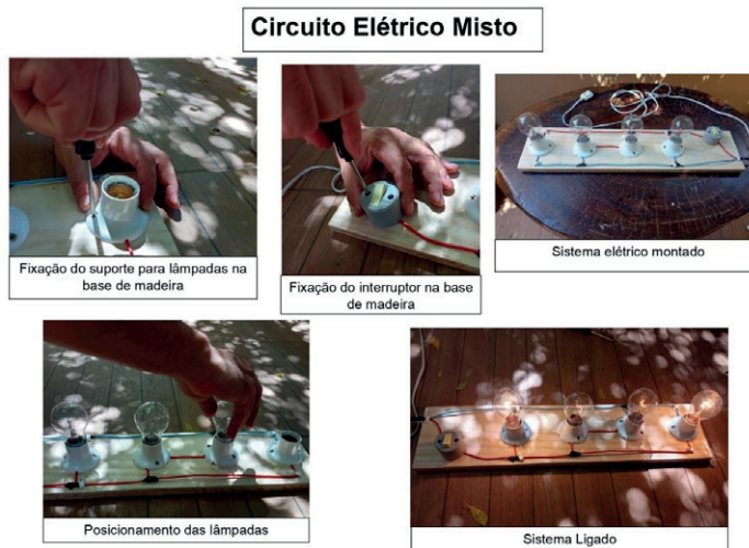
Figura 3. Experimento para explicação demonstração do conteúdo corrente elétrica, potencial elétrico, tensão elétrica, elementos eletrônicos, campo elétrico, magnetismo, campo eletromagnético, entre outros.
