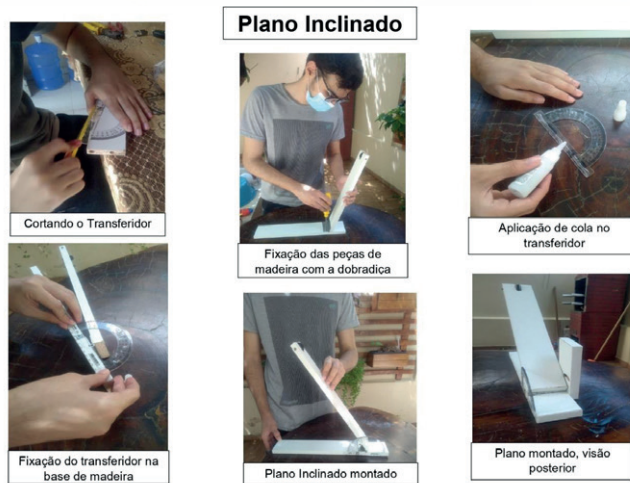
Figura 7. Experimento para demonstração do conteúdos como Força, Vetores, decomposição de vetores, Leis de Newton, Atrito, entre outros.
