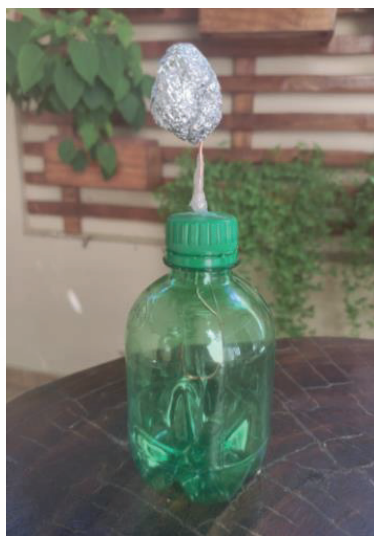
Figura 2. Equipamento ideal para explicação de conteúdos de eletrostática, como as cargas elétricas e suas propriedades, bem como o processo de eletrização por indução
