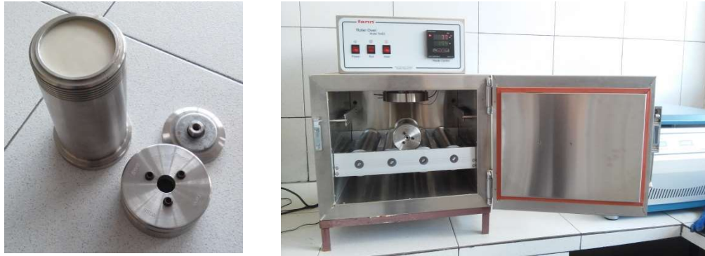
Figura 2 – (a) Célula de envelhecimento, (b) Equipamento Fann Estufa Rotativa Roller Oven. Fonte:
