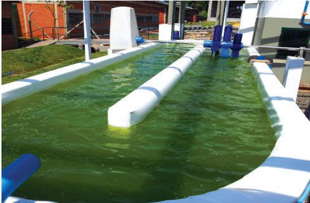
Figura 1: Sistema de cultivo raceway .
