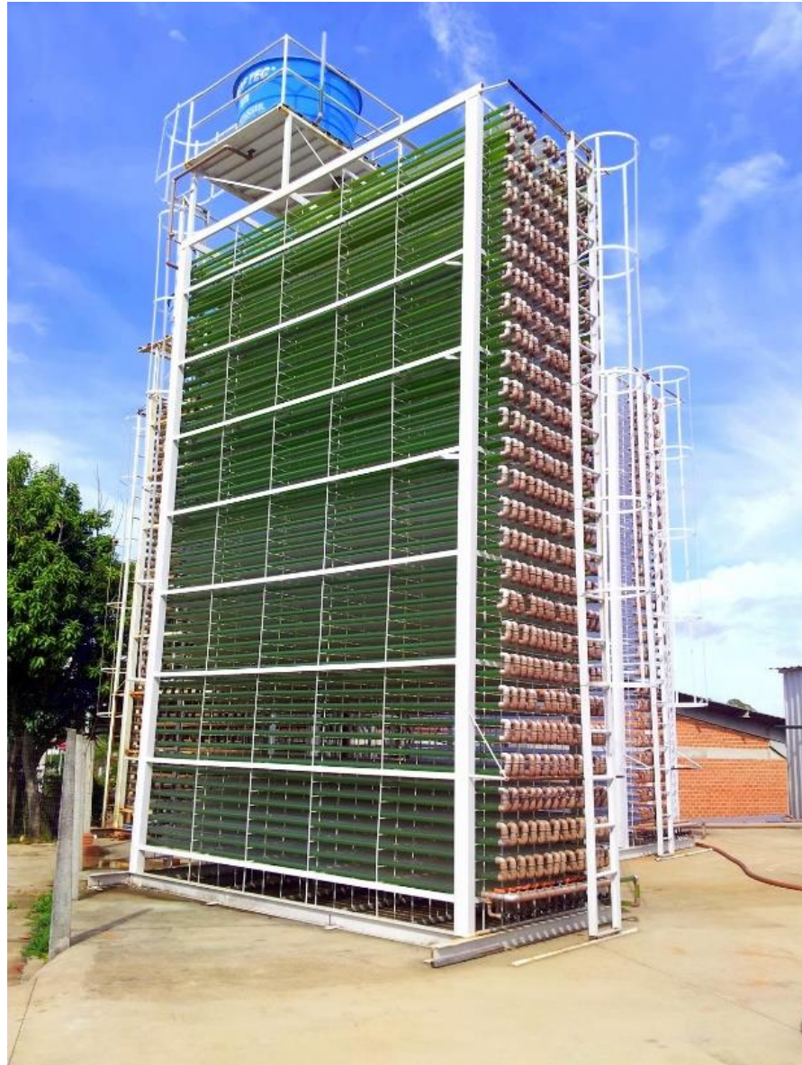
Figura 2: Sistema de cultivo em fotobiorreatores.
