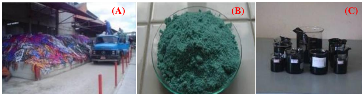
Figura 2 - (A) Resíduos poliméricos RCA, (B) Resíduo moído e (C) Ligante asfáltico. Fonte: (A) o autor (2012) e (B) e (C) CAMBUIM (2004).
