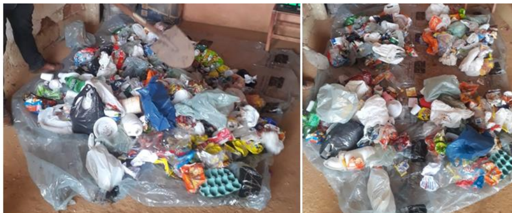
Figura 3. Método de quartejamento usado para obtenção da amostra desejada
