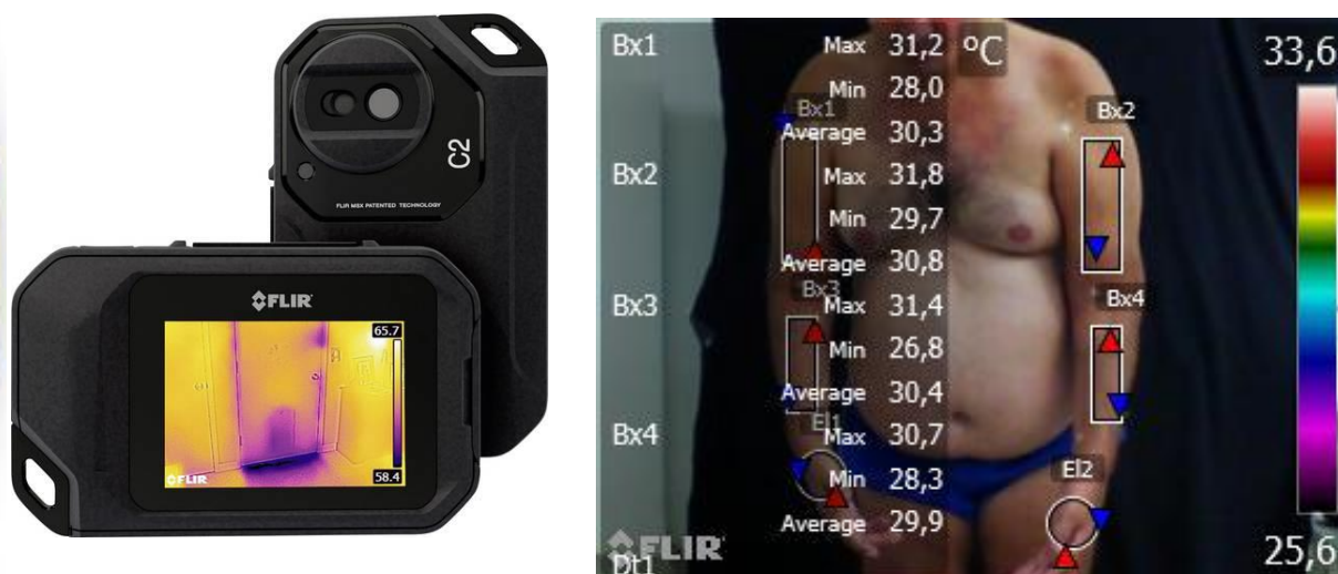
Figura 1 - Termovisor marca Flir modelo C2 e Termograma com a delimitação das RCI.
