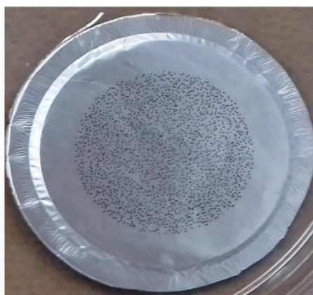
Figura 3- partículas impactadas em substrato de alumínio de estágio 9.
