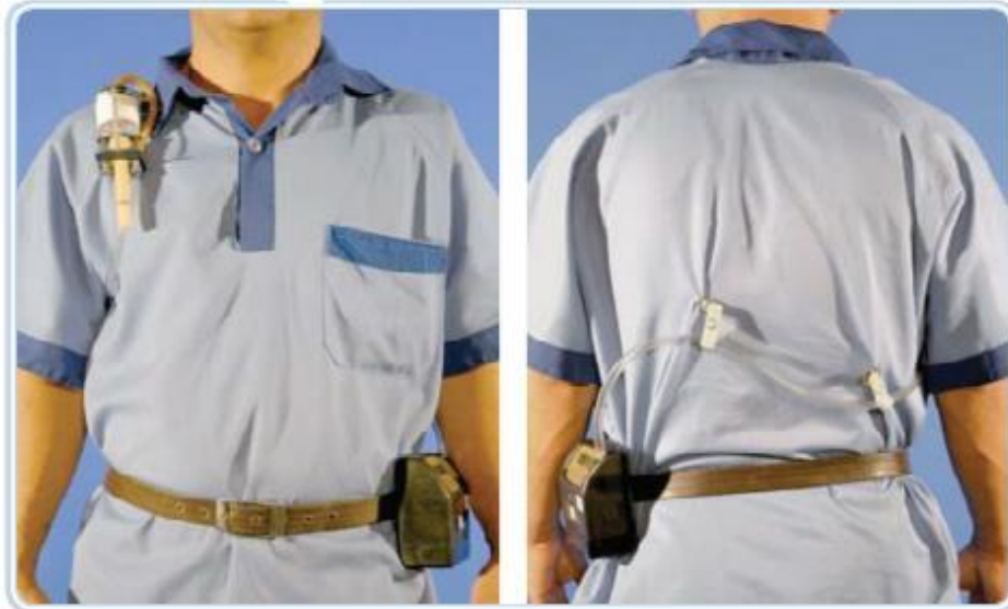
Figura 1 - Imagem esquemática coleta de amostra de chumbo no ambiente de trabalho para determinação do teor de chumbo presente no ambiente de trabalho.
