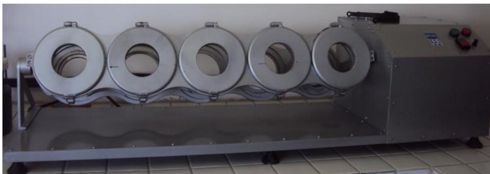
**Figura 03** – Reator de Lixiviação de Minérios (Normas NBR 10.005 da ABNT)
