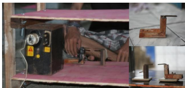
Figura 4. Construção e montagem do centelhador.
