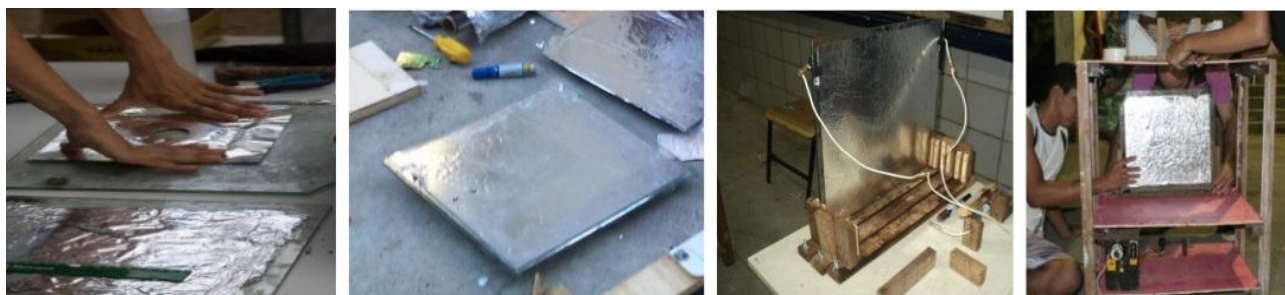
Figura 3. Fotos com as etapas da montagem e preparação dos capacitores planos.
