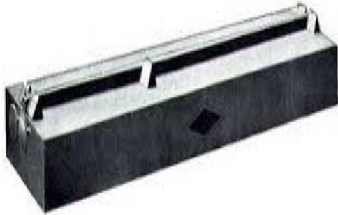
Figura.2 – Monocórdio. Madeira que fixa uma corda entre dois pontos, e com um dispositivo é permitido dividir essa corda em algumas partes.
