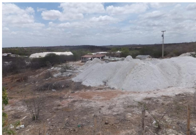
Figura 2: Rejeito proveniente do beneficiamento do caulim na Paraíba. Fonte: Própria, 2014.
