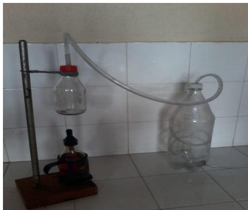
Figura 1: Destilador confeccionado com materiais alternativos
