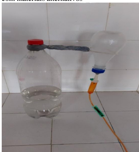
Figura 2: Funil de separação confeccionado com materiais alternativos
