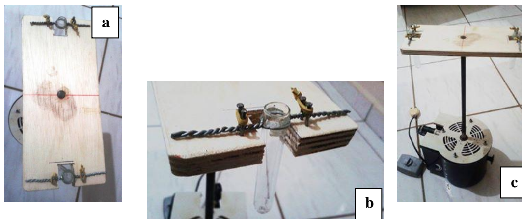
Figura 2. Centrífuga produzida pelos alunos.
