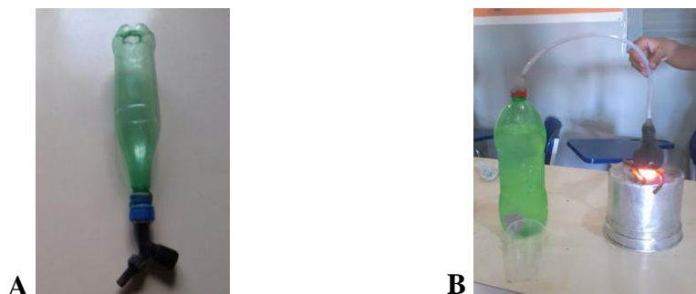
Figura 1. A - Funil de decantação produzido pelos alunos. B - Destilador produzido pelos alunos.
