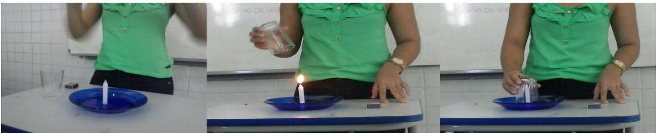
**Figura 1.** Primeiro experimento, demonstração da importância do oxigênio para o processo de combustão e a liberação do  $CO_2$ . A imagem demonstra os três passos, respectivamente. Foto registrada por uma aluna.
