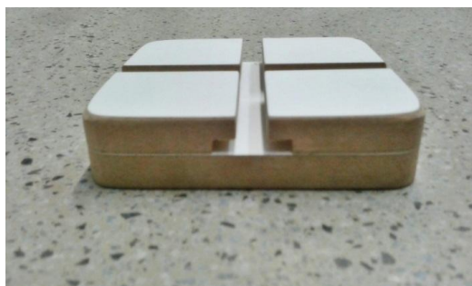
Figura 04: Base pronta do Elipsógrafo
