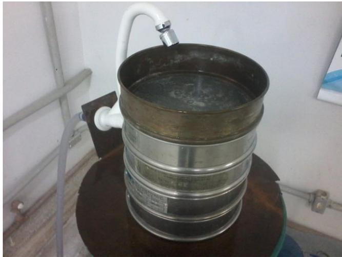
Figura 3. Peneiramento a úmido.
