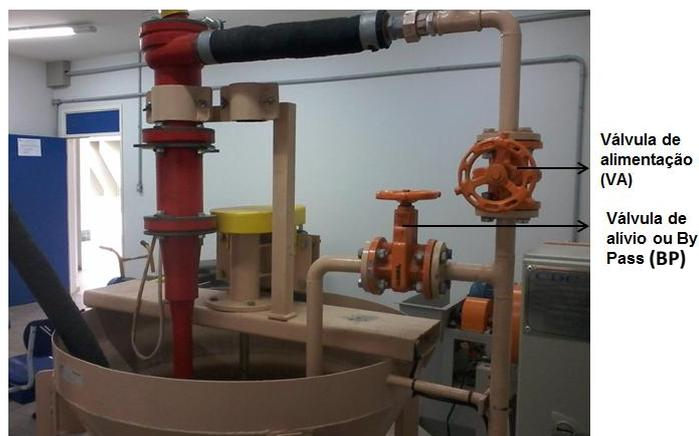
Figura 2. Unidade de hidrociclonagem, em destaque as válvulas de operação.
