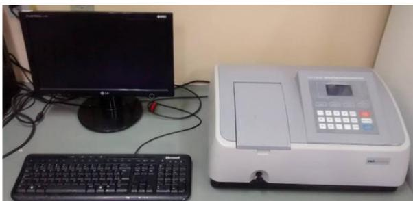
**Figura 4.** Espectrofotômetro UV – 1600 da Pró-Análise.
