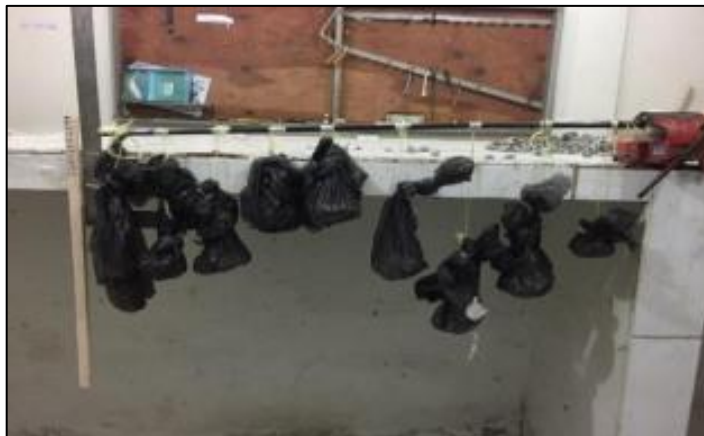
Figura 7- Ensaio estático da longarina principal Fonte: EQUIPE PARAHYASAS, 2017.
