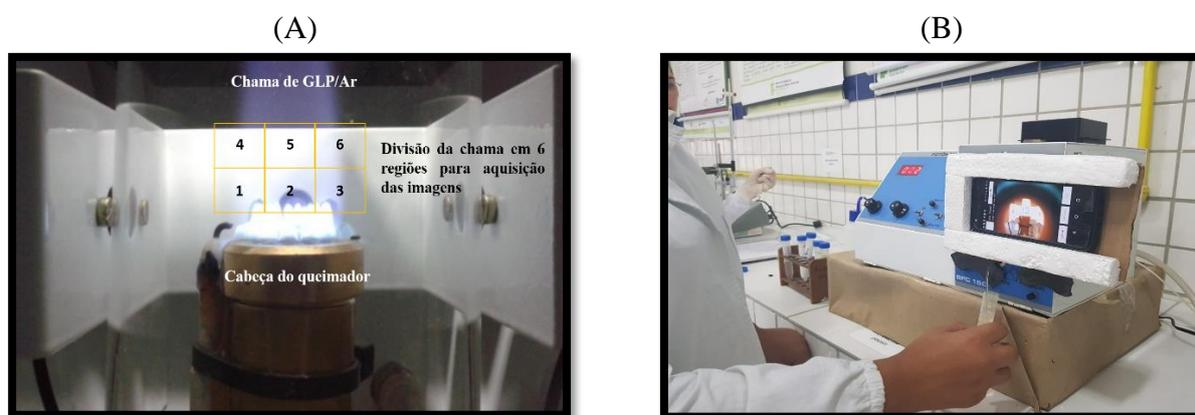
**Figura 1.** (A) Chama com as seis regiões escolhidas para estudo de sensibilidade na análise de Li; (B) suporte utilizado para aquisição das imagens digitais utilizando o smartphone em um suporte confeccionado com materiais de baixo custo como isopor e papelão.
