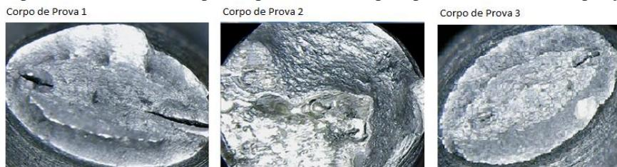
Figura 3- Aspecto da fratura dos corpos de prova soldados pelo processo FCAW-G. Ampliação de 500x
