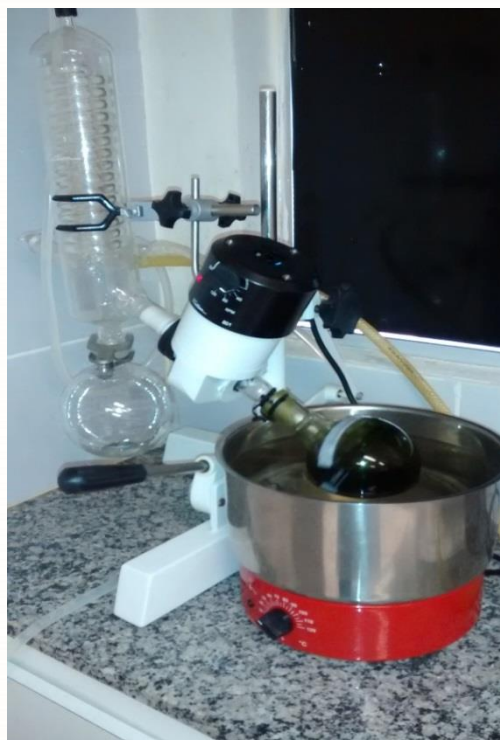
Figura 1: Extrato sendo submetido a rotaevaporação.;
