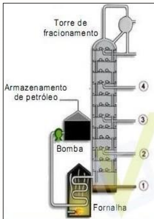
Figura 5. Esquema da destilação fracionada do petróleo
