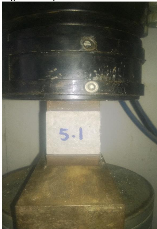
Figura 3 - Aparelho do ensaio de Resistência à Compressão.
