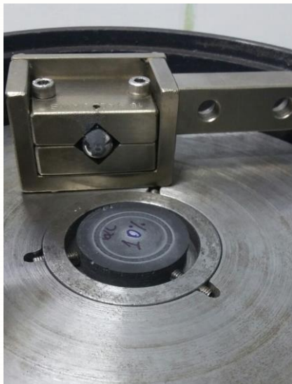
Figura 1 - Equipamento onde fora realizado o ensaio desgaste Pino-disco.
