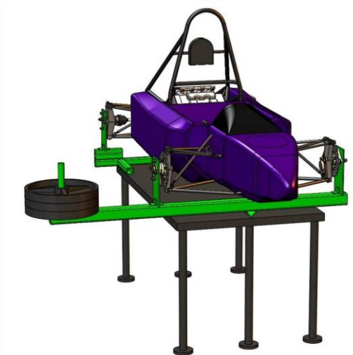
Figura 2: Projeto de bancada para um monocoque de um fórmula SAE.
