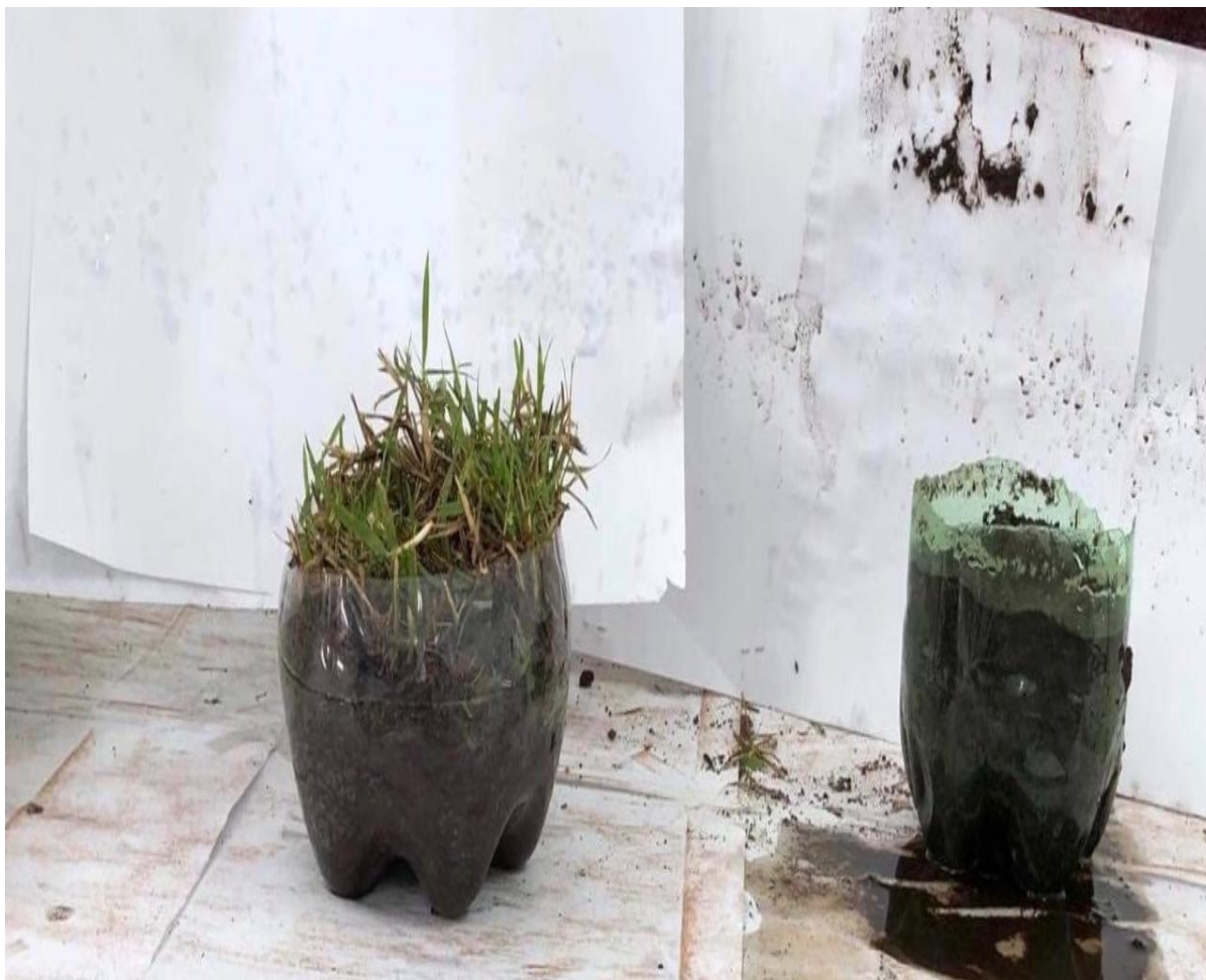
Figura 2. Resultado do experimento sobre o impacto da gota de chuva no solo
