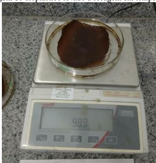
Figura 2: Pesagem do bioplástico levado à secagem em temperatura ambiente.
