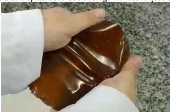
Figura 4: Resistência do bioplástico levado à secagem em condições de temperatura local.
