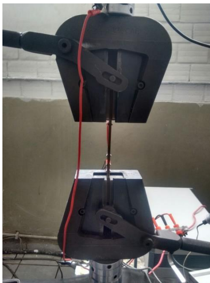
Figura 2 - Ensaio de tração e utilização da técnica A.C.P.D. Fonte: autoria própria.
