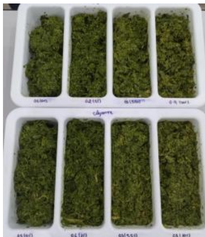
Figura 3. Substratos e biorreatores utilizados na fermentação semissólida
