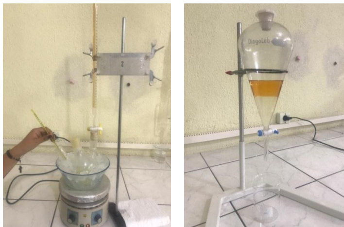
Figura 3. Processo de produção e purificação do biolubrificante de óleo de soja residual.
