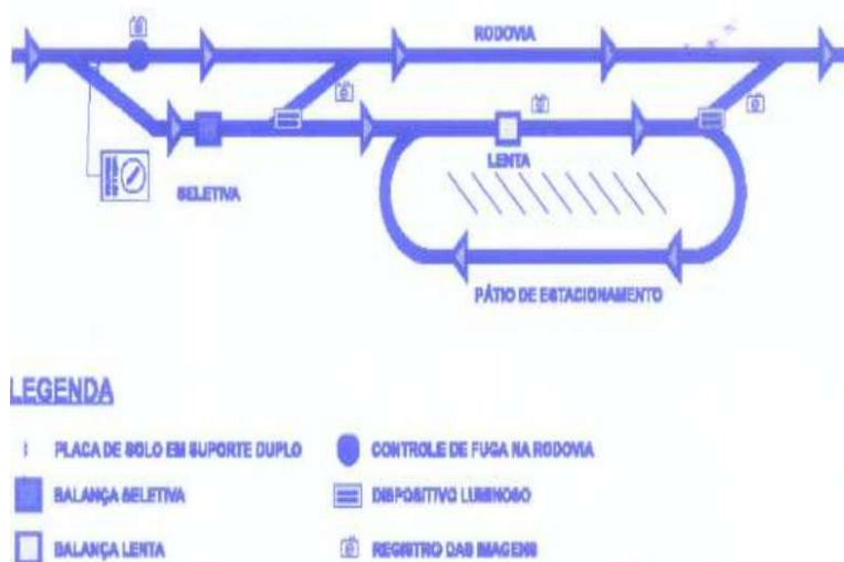
Figura 1. Quadro esquemático do PPV Fonte: Resolução CONTRAN nº 902/2022
