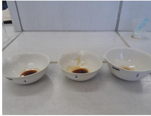
Figura 1 – Cápsulas com respectivas amostras para determinação de resíduo seco
