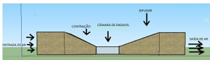
Fig. 5. Detalhamento estrutural do Túnel de Vento Desenvolvido com o software Google Sketchup.
