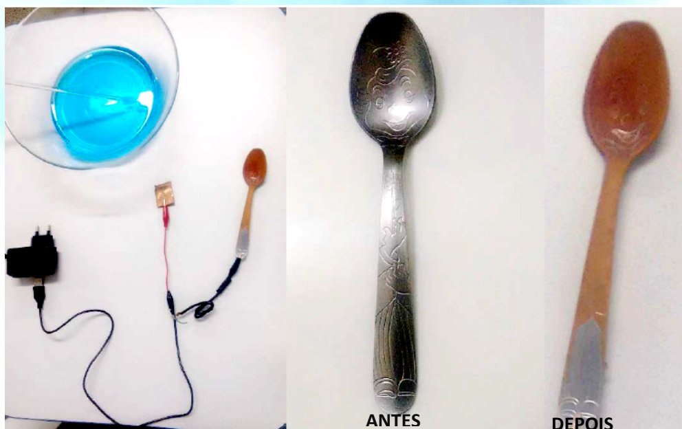
Figura 3. Sistema eletrolítico (esquerda), colher antes da cobreação (centro) e após a deposição de cobre (direita)
