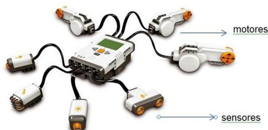
**Fig.01** – Motores e sensores conectados ao bloco programável nxt 2.0
