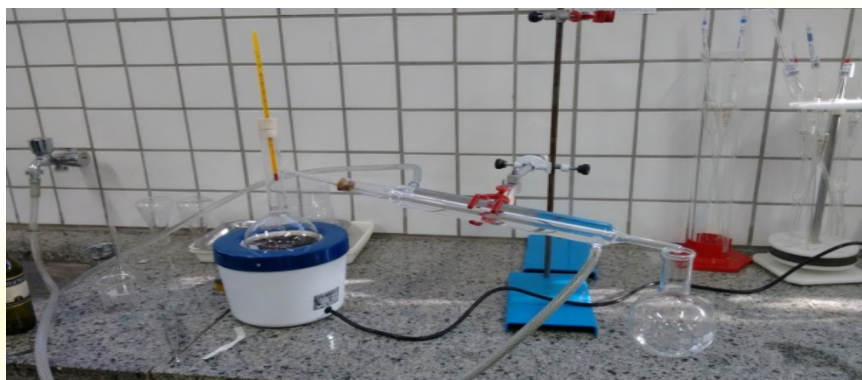
Figura 7 - Destilação do Vinho Tinto feita no laboratório de Química (IFMA CAXIAS)
