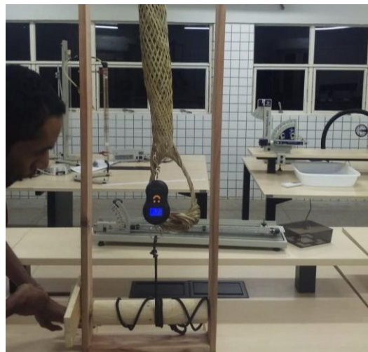
Figura 4-Medindo a força aplicada ao tipiti.
