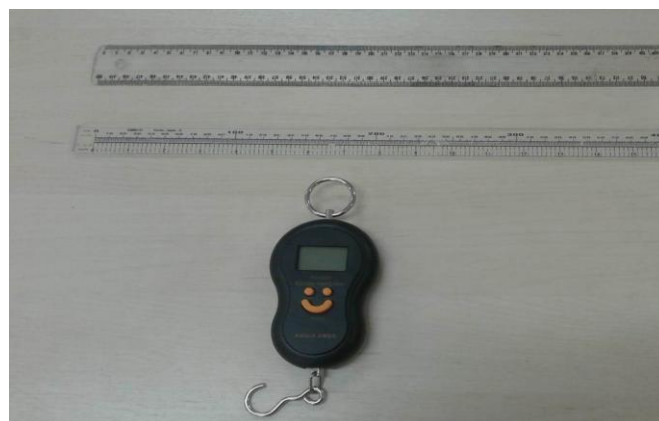
Figura 2: Dinamômetro digital para leituras em libras ( lb ) e a régua.
