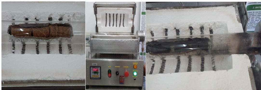
Figura 3: Processo de pirólise do briquete da fibra de Coccoloba nucifera L.
