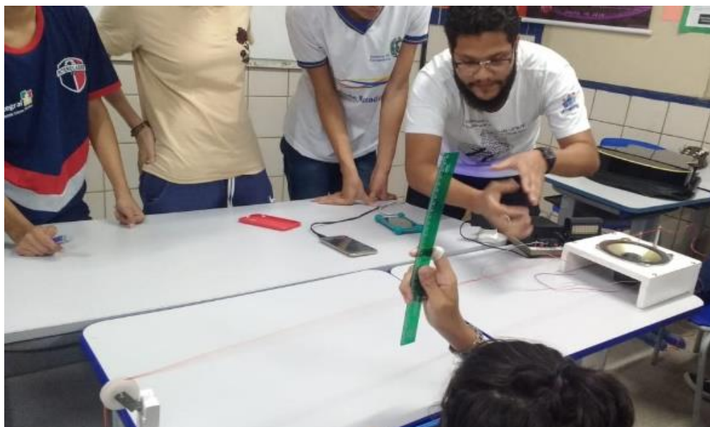
Figura 3 – Medição da amplitude de uma onda estacionária.
