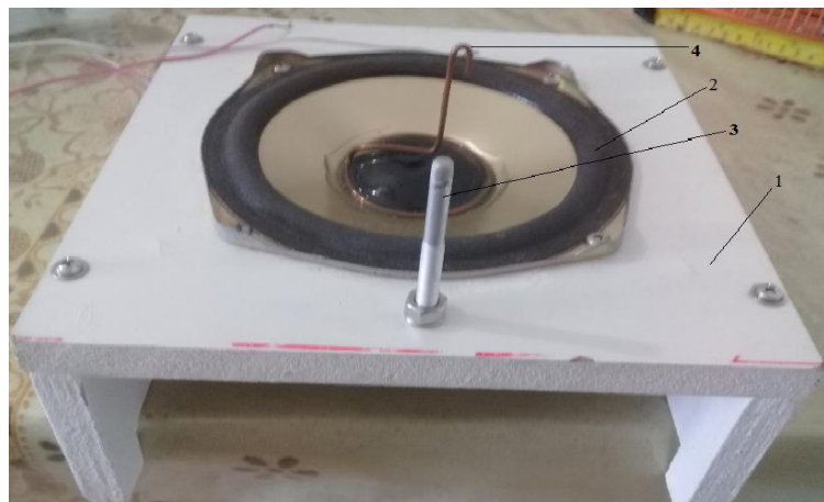
Figura 2: base de madeira com alto-falante acoplado. vista superior.
