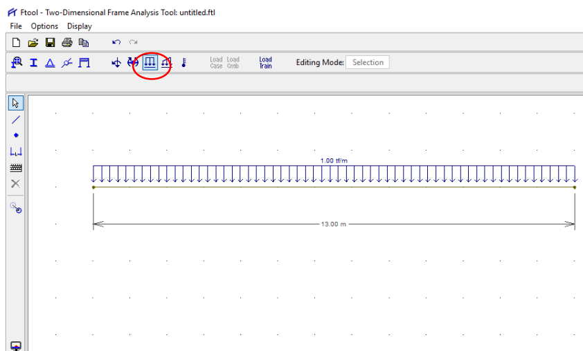
Figura 06: Carga distribuída aplicada a estrutura
