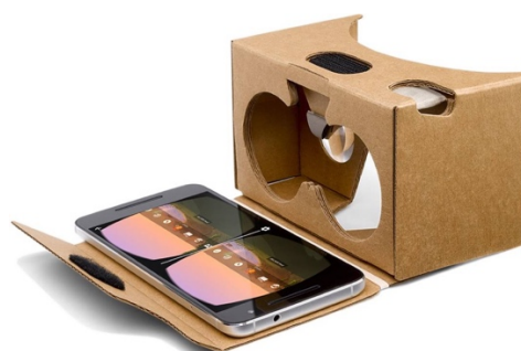
Figura 1 – Fotografia de um Google Cardboard aberto, com o espaço para acoplar o celular, cuja tela será o monitor do HMD.
