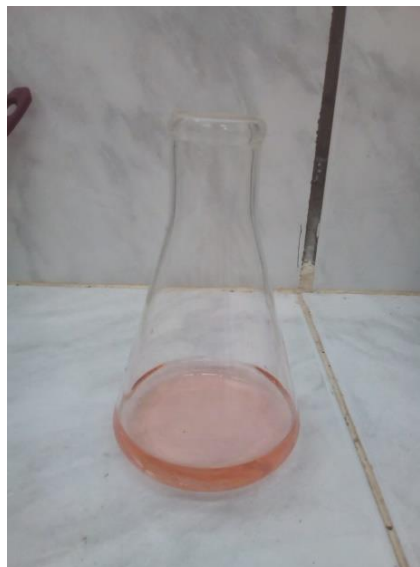
Figura 4 Análise Titulométrica de Bicarbonato depois da adição de reagente
