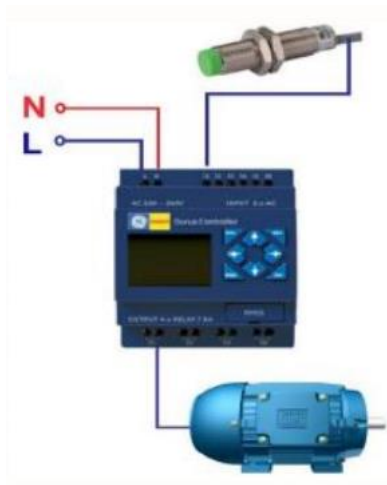
Figura 6 - Exemplo de dispositivos de entrada e saída do CLP
